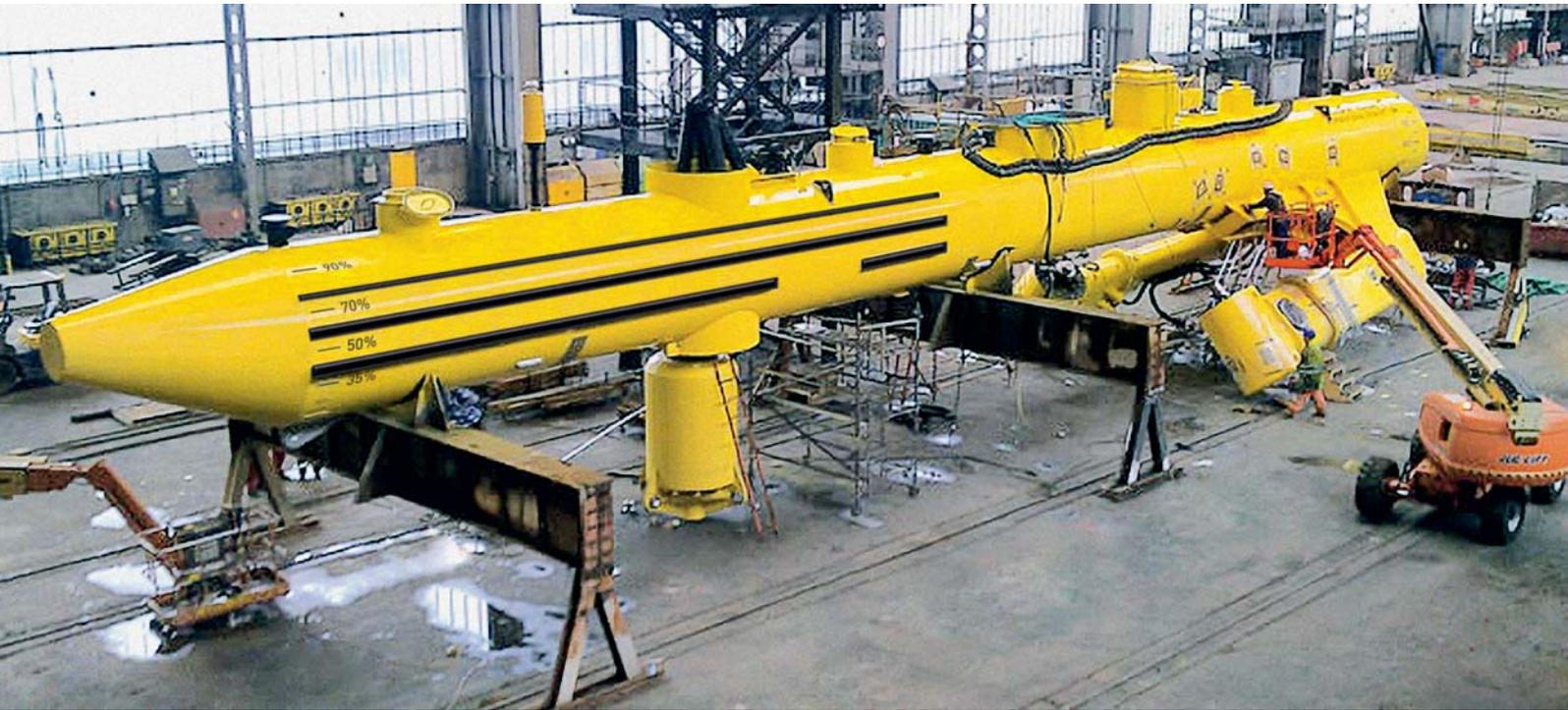
Die Fertigung der Gezeitenturbine, die speziell für die anspruchsvollen Bedingungen in der Nordsee entwickelt wurde.
