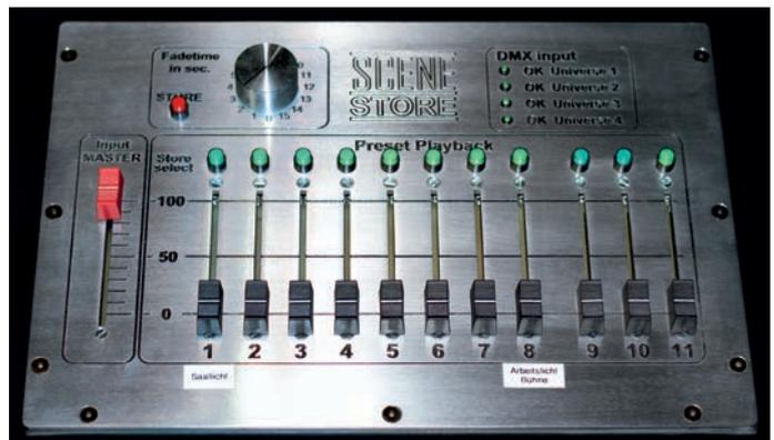
Für Proben oder zur Sicherung der Beleuchtungstechnik im Falle einer Havarie hat Stage Entertainment eine zweite vom Lichtmischpult unabhängige Lichtsteuerung, die Scenestore, im Einsatz.
