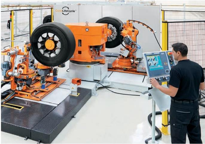
Bei der Heißbründerneuerung sorgt der Bediener über das Control Panel CP7931 von Beckhoff – mit 12-Zoll-Touchdisplay, alphanumerischer Tastatur und Tastererweiterung – für das zuverlässige Aufbringen einer neuen Gummimischung auf Lauffläche und Seitenwand des Lkw-Reifens.
