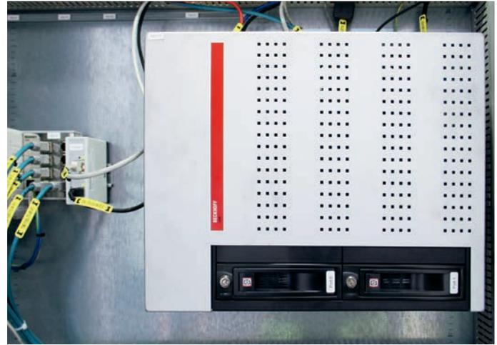
Der Schaltschrank-PC C6650 bietet ausreichend Rechenleistung, um auch größere Mehr-Achs-Maschinen zuverlässig zu steuern.
