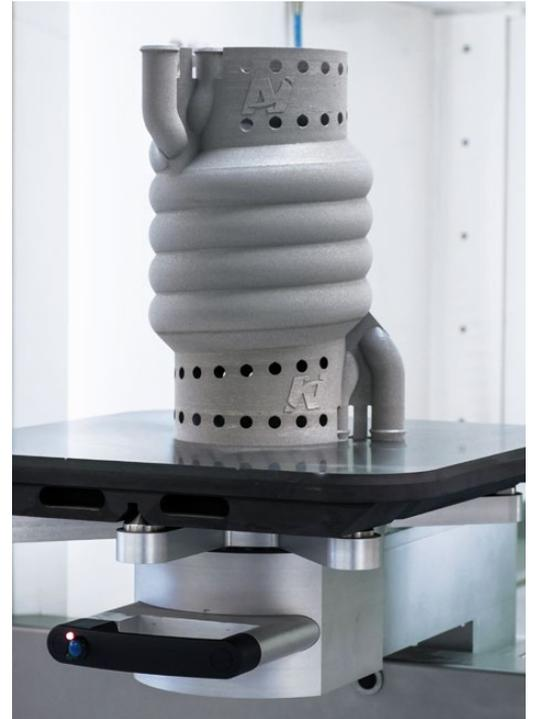
Ein im 3-D-Druckverfahren hergestellter Wärmeaustauscher
