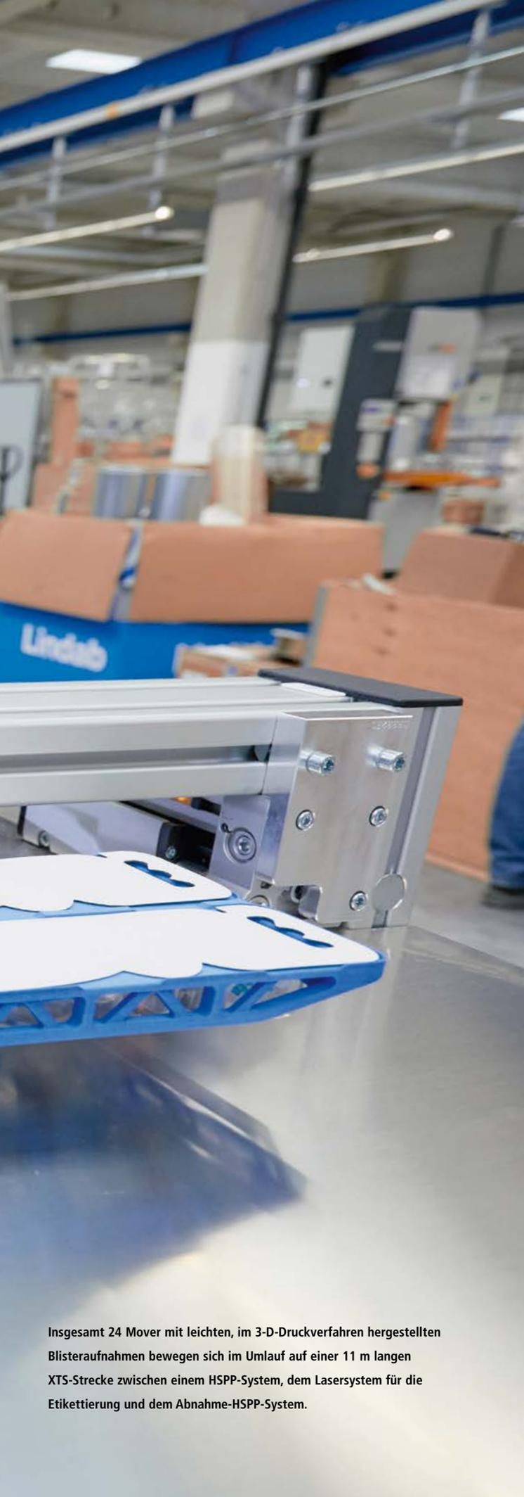
Insgesamt 24 Mover mit leichten, im 3-D-Druckverfahren hergestellten Blisteraufnahmen bewegen sich im Umlauf auf einer 11 m langen XTS-Strecke zwischen einem HSPP-System, dem Lasersystem für die Etikettierung und dem Abnahme-HSPP-System.
