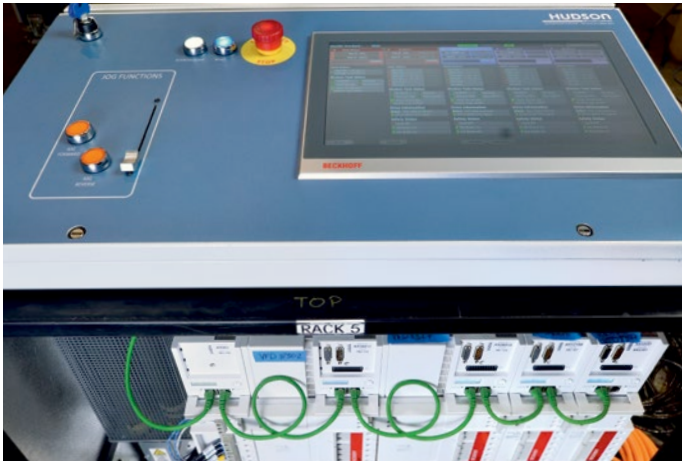
Die von Hudson programmierte HMI-Software kommt auf den 15-Zoll-Multitouch-Control-Panels des Typs CP2916, zum Ablauf.
