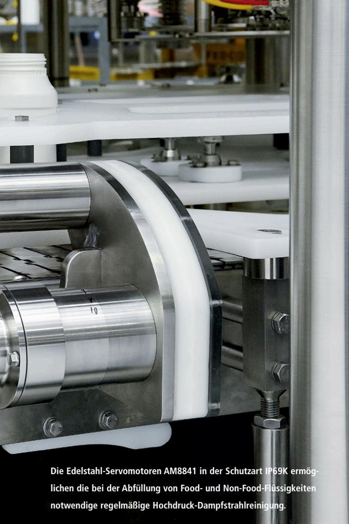
Die Edelstahl-Servomotoren AM8841 in der Schutzart IP69K ermöglichen die bei der Abfüllung von Food- und Non-Food-Flüssigkeiten notwendige regelmäßige Hochdruck-Dampfstrahlreinigung.
