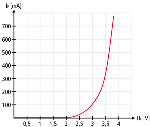
Abbildung 1: Beispielhafte Kennlinie einer LED
