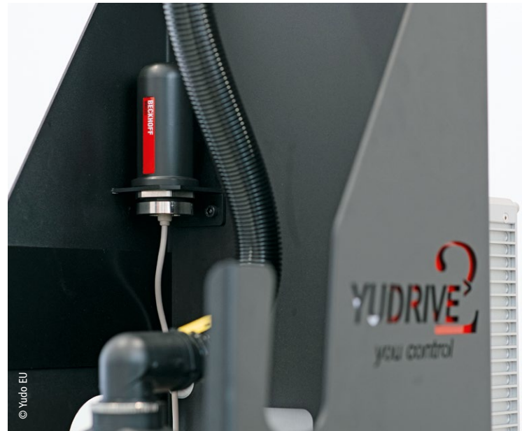
Ein WLAN-USB-Stick, der im IP66-Gehäusedom CU8210-M001 montiert ist, erleichtert den Systemzugang vor Ort.
