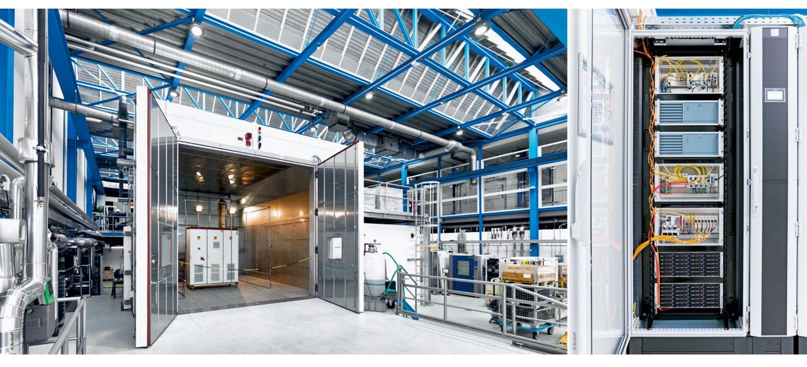
Automatisierung eines 10-MVA-Prüfstands für Windenergieanlagen
