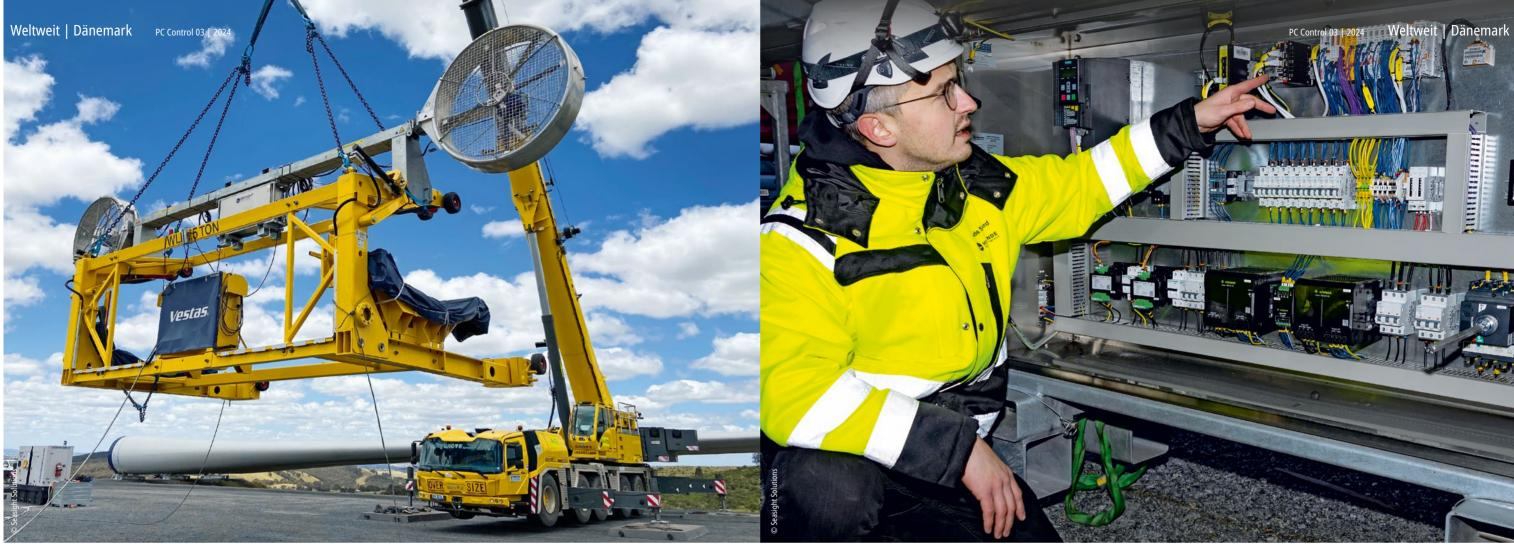
Es erfordert eine performante Automatisierungsplattform, um die Positionen der Rotorblätter selbst bei starkem Wind präzise auf Position zu halten. Mit PC-based Control und TwinCAT hat Seasights Solutions die ideale Steuerungslösung dafür gefunden.
