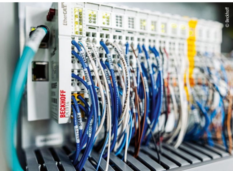
Platzsparende EtherCAT-Klemmen und -Buskoppler, darunter der Koppler EK1914 mit TwinSAFE-Funktionalität, verbinden Hochgeschwindigkeits-Echtzeitkommunikation mit funktionaler Sicherheit.
