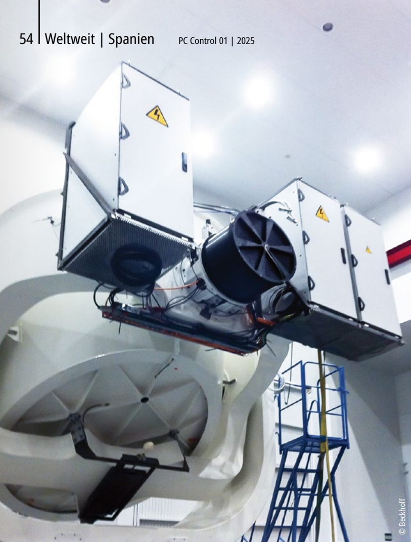
Das Quijote-I-Teleskop mit den Achsen zur vertikalen Ausrichtung (Elevation) und Instrumenten-Schränken.
