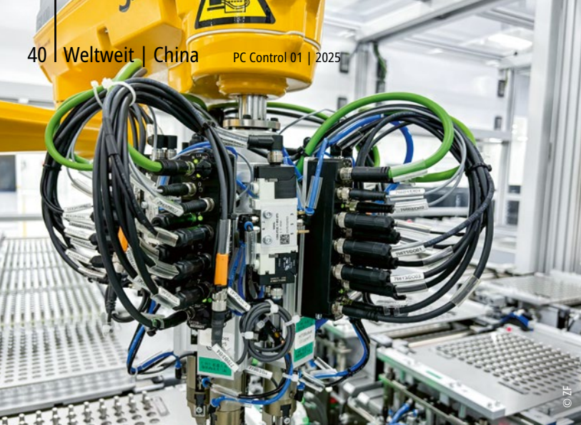
Das breite Spektrum der EtherCAT-I/Os von Beckhoff umfasst auch direkt vor Ort montierbare IP67-Box-Module.
