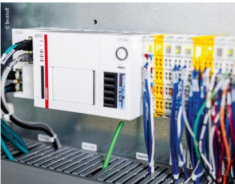
Als zentrale Steuerung der Versandverpackungsmaschine 1400-GEC trägt der Embedded-PC CX2033 zur Reduzierung der Zykluszeiten bei.
