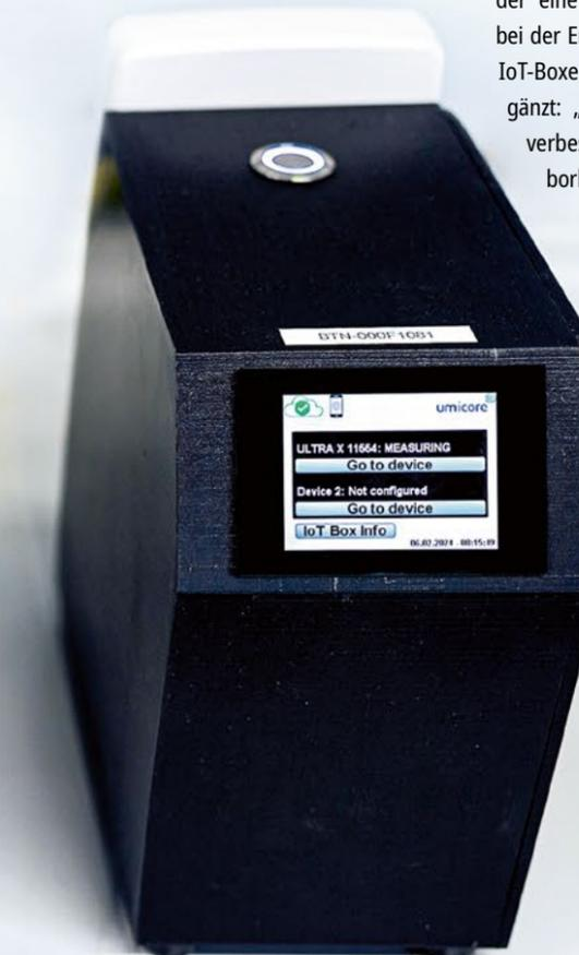
Die mit der TwinCAT-Kleinststeuerung realisierte IoT-Box schafft in Verbindung mit den digitalen Tools von Umicore Automotive Catalysts die Voraussetzung für die Transformation des Laborbetriebs.
