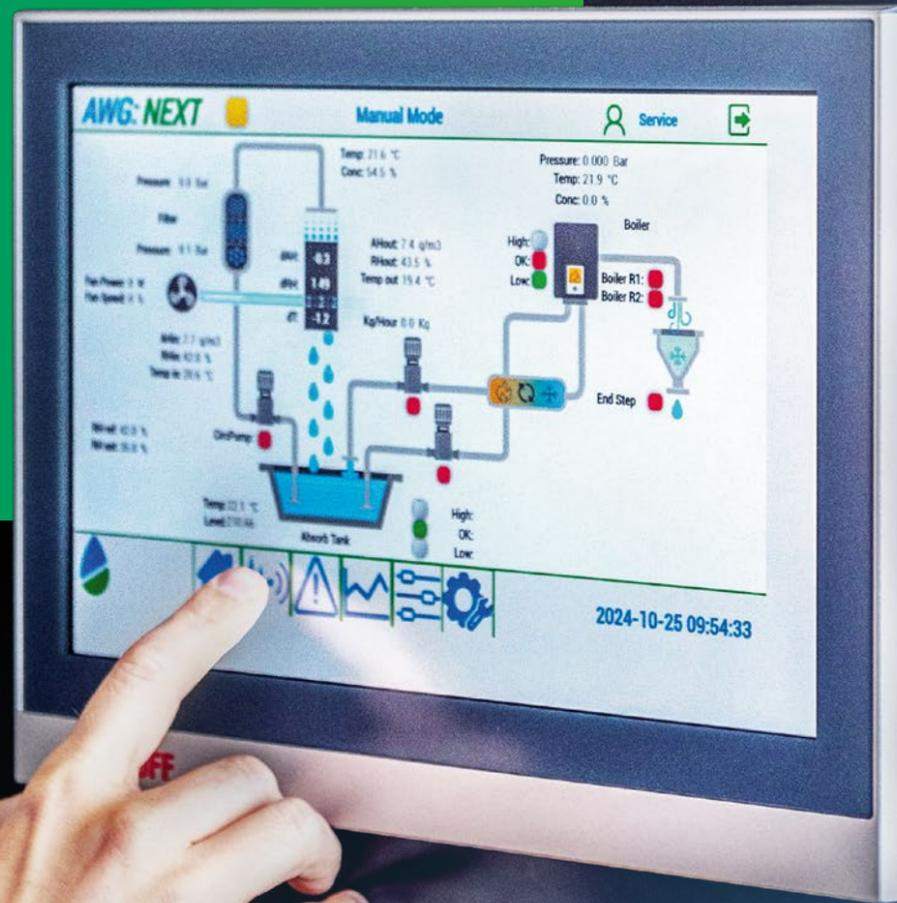
Über die mit TwinCAT HMI realisierte Visualisierung lassen sich am Control Panel die Parameter des Luftentfeuchters aufrufen und anpassen.
