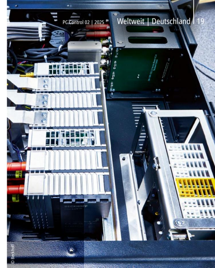
Neben den EJ-Modulen (r.) sowie EtherCAT-Klemmen der EL-Serie kommen beim MTS auch die hochpräzisen EtherCAT-Messtechnikklammern der ELM-Reihe (l.) zum Einsatz (hier im Modul MDU).
