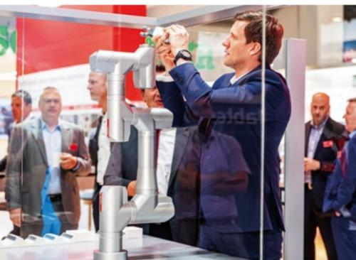
ATRO ist ein modularer, vollständig in TwinCAT integrierter Industrieroboter-Baukasten, mit dem sich individuell und flexibel optimale Roboterstrukturen für unterschiedliche Applikationen zusammenstellen lassen.
