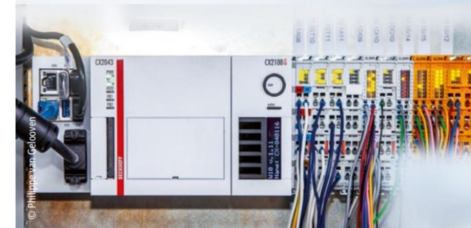
Seit zwei Jahren setzt CNC Solutions auf PC-based Control und Embedded-PCs CX2043 als Steuerung für die unterschiedlichsten Projekte.
