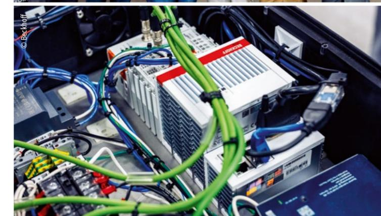
In den transportablen Steuerungskästen der Fire Snake sind die Embedded-PCs CX5140 und CX8190 mit direkt angereichten EtherCAT-Klemmen platzsparend installiert (hier im Bild CX5140).
