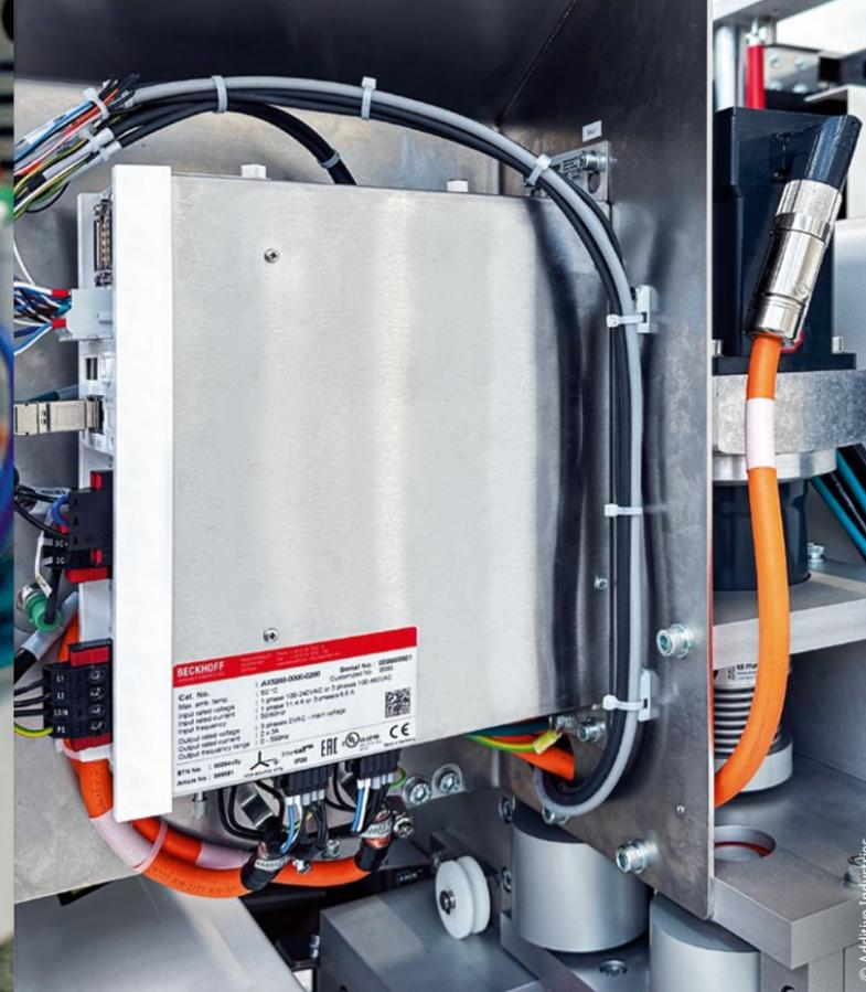
Der 3D-Druck verlangt präzise Bewegungsabläufe, die Additive Industries mit Servoverstärkern AX5000 und Servomotoren AM8000 realisiert.
