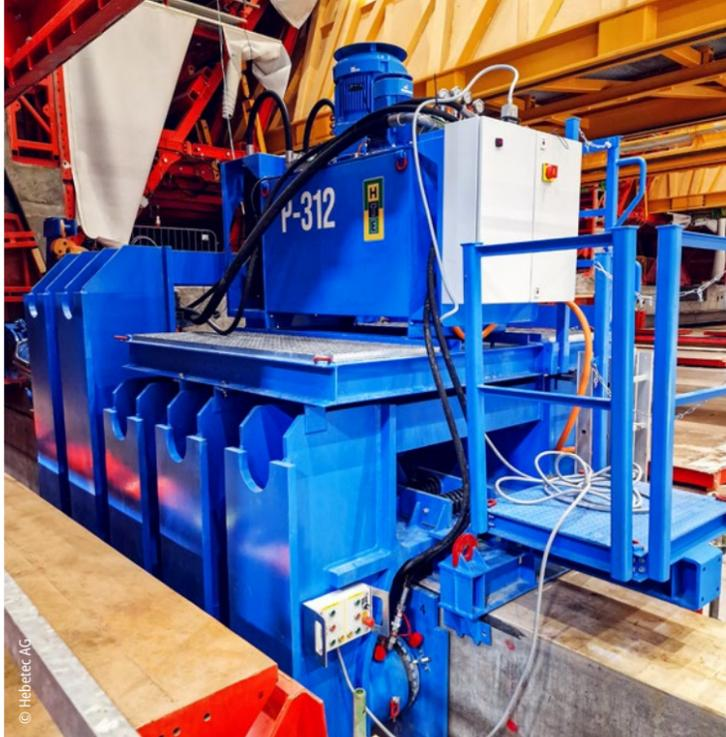
Sechs dieser Pusher mit jeweils zwei Zylindern schieben die Tunnelsegmente während der kontinuierlichen Fertigung gleichmäßig über mehrere hundert Meter durch ein enges Tor bis ins Trockendock.
