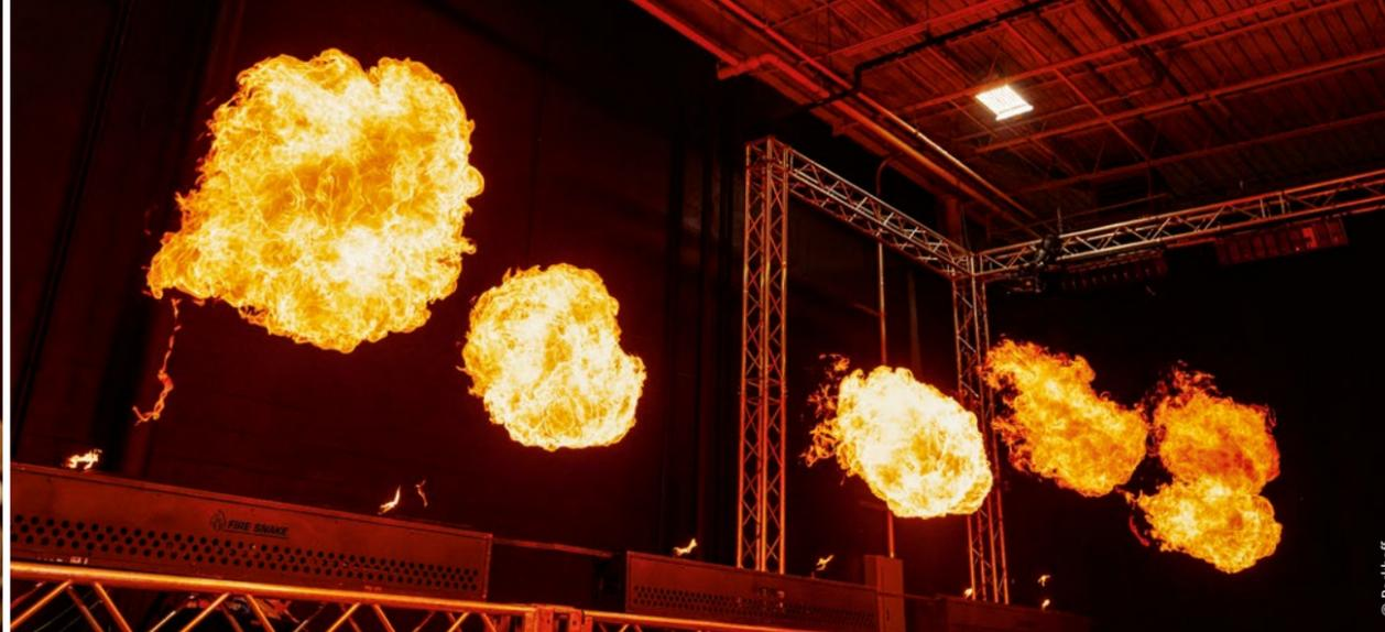
Die propangasbetriebenen Brenner erzeugen kontinuierliche Flammen in stufenlos regelbarer Höhe von bis zu 1,80 m sowie mit Berstventilen rollende Feuerbälle.
