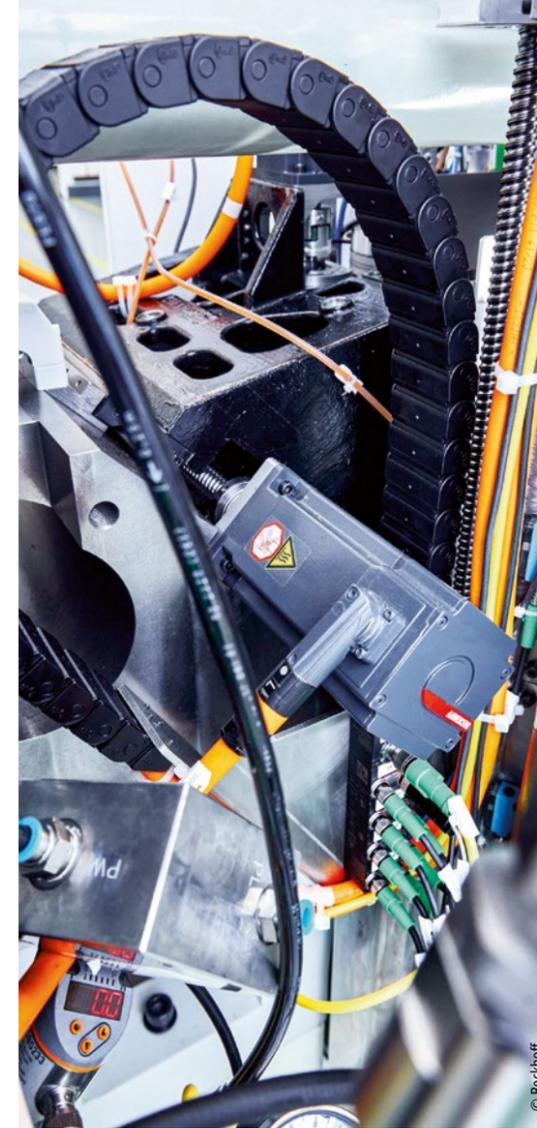
Die One Cable Technology (OCT) als Anschlusstechnik für die Servomotoren AM8000 und AM8100 spart Montagezeit und Platz.
