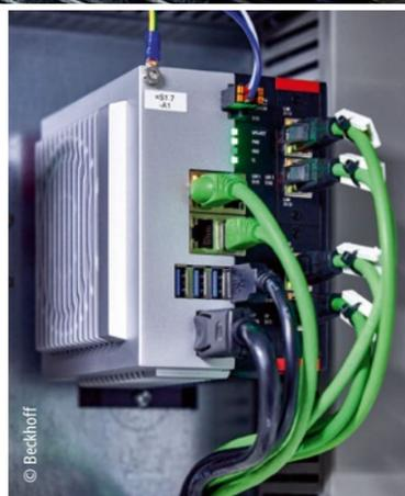
Ein Ultra-Kompakt-Industrie-PC C6032 mit acht CPU-Kernen steuert die komplette Anlage; um die notwendige Zykluszeit von 1 ms einzuhalten, wurden die Antriebe und die I/O-Ebene über insgesamt fünf EtherCAT-Stränge eingebunden.
