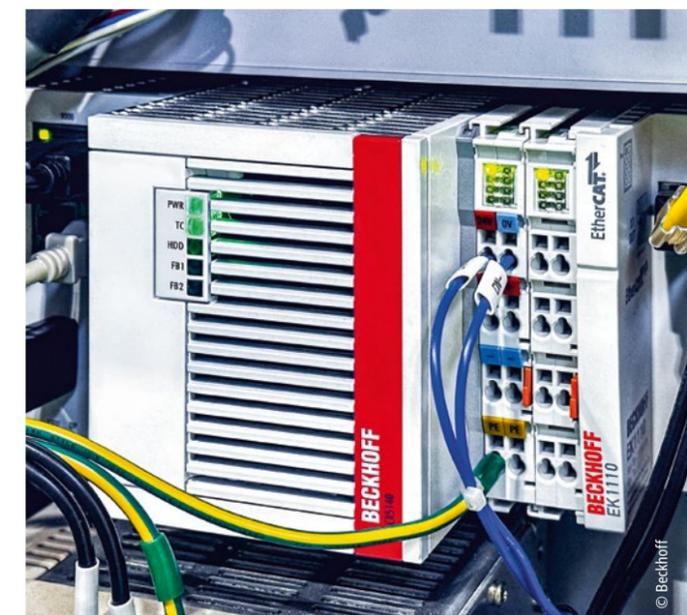
Der Embedded-PC CX5140 bildet den leistungsfähigen Steuerungskern der Spritzgießmaschinen.
